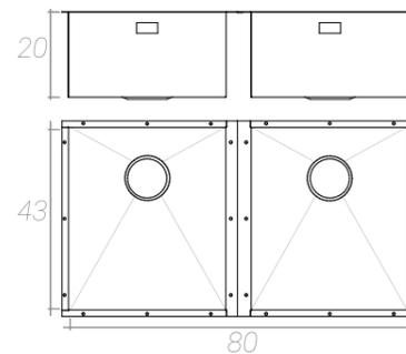
Lavello a 2 vasche (37x43), Aisi 304, inclusa piletta 2 vie + sifone, con traversino 6cm. Bordo da 1,5cm. Possibile utilizzo sia con fondo a vista sia rivestito.
