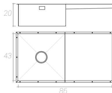
Lavello a 1 vasca (43x43) + gocciolatoio, Aisi 304, inclusa piletta a 1 via + sifone, bordo da 1,5cm. Possibile utilizzo sia con fondo a vista sia rivestito. Reversibile.
